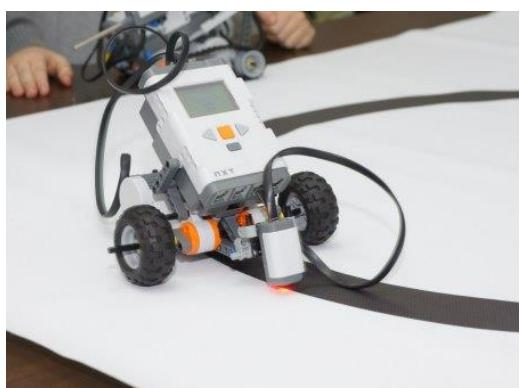
В рамках данного проекта предполагается создание учащимися мобильного робота, реализующего перемещение по заданной траектории (линия черного цвета на белом поле), а также написание программы для этого робота. Проект включает в себя практическое использование датчиков и сервомоторов, а также создание и отладку программ.
